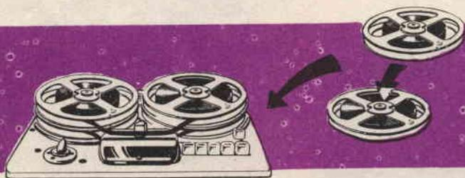
Fig. 6. È possibile utilizzare un solo registratore per trasferire la registrazione di un nastro magnetico ad un'altro, accoppiando due coppie di bobine ed inserendo una testina di lettura supplementare.
